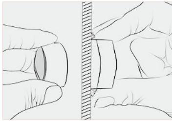
将操作头部由面板前方插入安装孔，于面板后旋入中座，然后均匀拧紧两端紧固螺钉（不可用力过猛，最大扭矩0.25N.m），如面板为塑料等其他非金属材料，可在面板后垫上一块安装板（见附件F5）后再安装，如安装孔的直径为25mm时，可在面板后垫上一块 $\varnothing 25$ 的安装板（见附件F6）后再安装。
